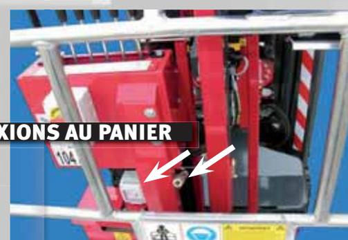
La prise de courant 230V et la prise pour l'air comprimé sont de série dans le panier.
