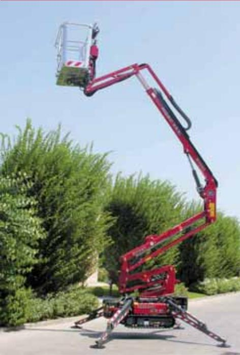
Parmi les nouvelles caractéristiques de série, la principale nouveauté est la **possibilité de commander la machine à distance, par une radiocommande** qui contrôle toutes les fonctions principales, c'est à dire: sélection des moteurs, autostabilisation, autodesstabilisation, écran interactif.
